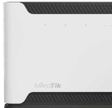
*Er ist ein Hochgeschwindigkeits-Dualband-Zugangspunkt für Zuhause mit einer leistungsstarken Quad-Core-ARM-CPU und unserem neuesten CAT6-LTE-Modem – für wirklich schnelles Internet überall und jederzeit. Aber LTE ist nicht die einzige Option - Chateau verfügt auch über 5 x Gigabit-Ethernet-Anschlüsse und einen USB-Anschluss in voller Größe für zusätzlichen Speicherplatz.*
