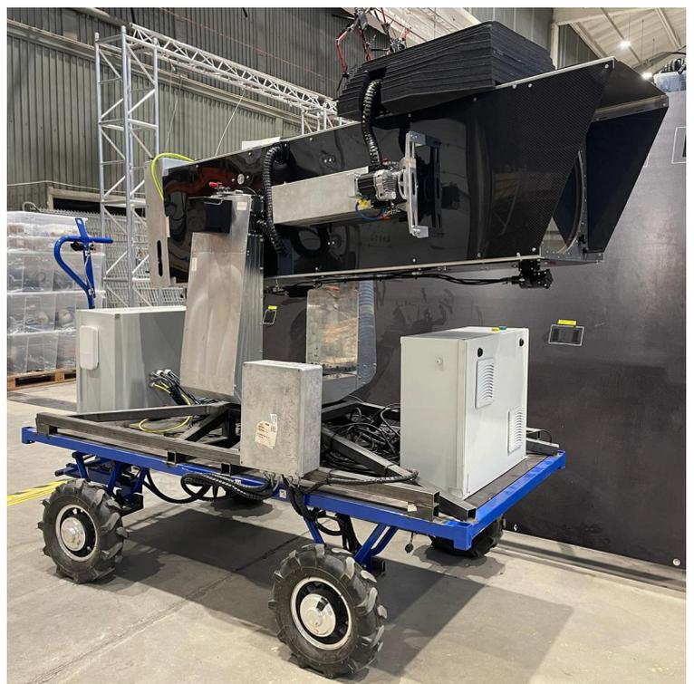
wAP ermöglicht die Fernsteuerung und die Übertragung von Diagnosedaten von Robotersystemen, die die Wartung von Windkraftanlagen durchführen. Das gesamte Robotersystem arbeitet ohne Ausfallzeiten für die Turbinen und gilt als wesentlich sicherer als die bisher eingesetzten Lösungen, die auf Drohnen basieren.
