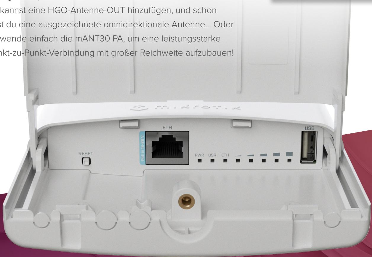
*Das wetterfeste Board ist mit einer modernen Qualcomm Maple-CPU auf ARM-Basis, 256 MB RAM, einem USB-Anschluss für zusätzlichen Speicher oder andere Anforderungen sowie einem Gigabit-Ethernet-Anschluss mit PoE-In ausgestattet.*
